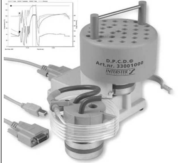
Şekil 08:11 İşleme karşı koyan cihazın dijital modeli (DPCD, İnterster, 3300-1000) görülmektedir. 10x11 cm boyutlarında, 410 gram ağırlığındadır, 3.6 voltluk bataryası vardır. Otoklav kabine yerleştirilir, çevirim boyunca 7200 okuma yaparak usb kablosu ile bilgisayar ekranına bilgi gönderir. Kabin sıcaklığını, heliks borunun içerisindeki sıcaklığı, o sırada olması gereken sıcaklığı, o sırada ölçülen kabin basıncı olmak üzere 4 farklı kanaldan kayıt yaparak, sterilizasyon sırasında ekranda grafik çizer.
