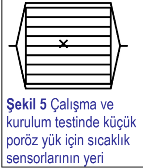
Şekil 4 Küçük poröz yük örnekleme testinde sıcaklık sensörlerinin yerleri.
